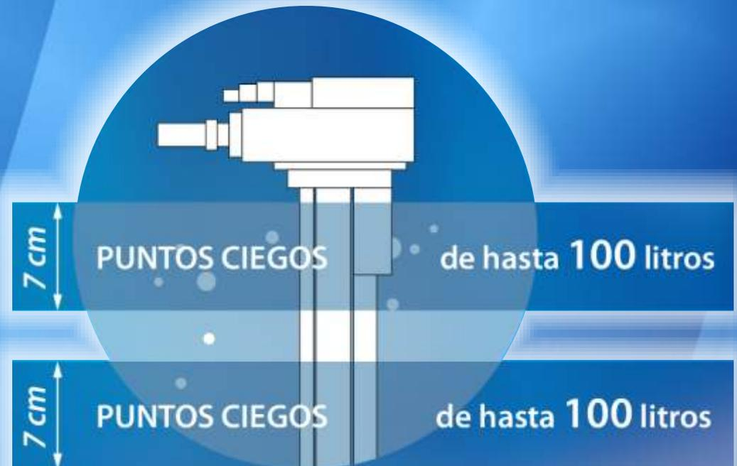
El CAN-bus tiene un punto ciego en la parte superior del tanque de combustible (que se incrementa cuando el sensor flotante choca con el limitador). Como resultado, el conductor puede drenar fácilmente hasta 100 litros de combustible desde un tanque lleno. El consumo de combustible cada 100 km. se calcula incorrectamente también.
